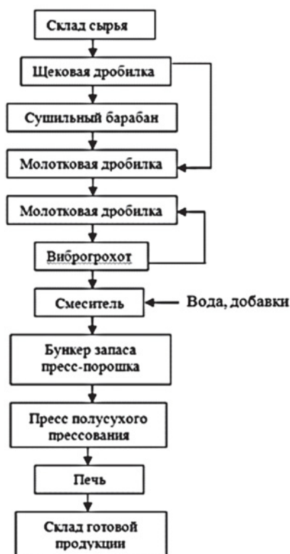
Рис. 1. Схема производства лицевого керамического кирпича на основе опоковидных пород
